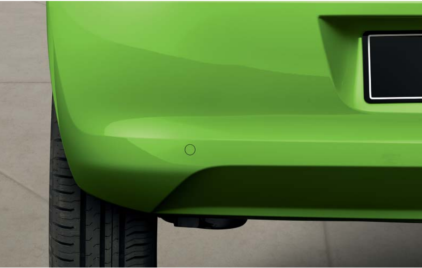
PARK DISTANCE CONTROL Zaparkovat vůz bude mnohem snazší a bezpečnější se signalizací vzdálenosti při parkování. Tři senzory, které hlídají vzdálenost vozu od překážky, jsou integrovány v zadním nárazníku.
