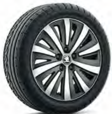
Kola z lehké slitiny DRAKON 17" (disk: 6,5J × 17" ET41, pneu: 215/55 R17)
